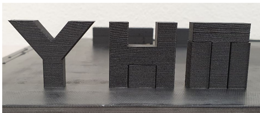
Obrázek 27: Nutnost podpory při 3D tisku modelu
