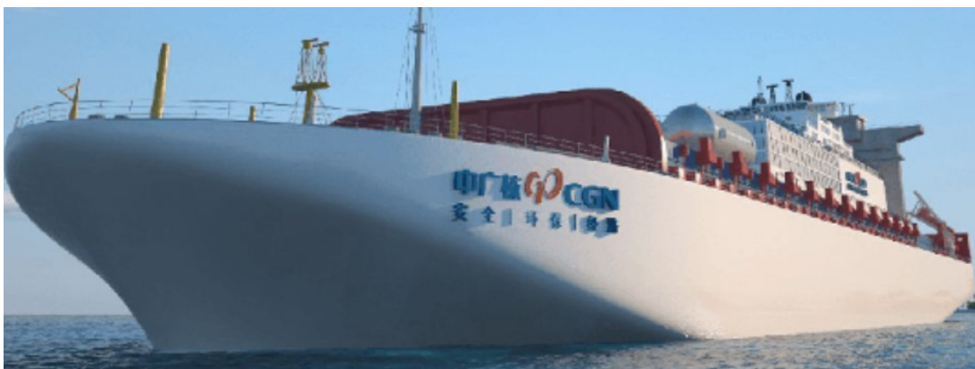
Obrázek 5: Ukázka čínské plovoucí jaderné elektrárny s reaktorem ACPR-50 S
