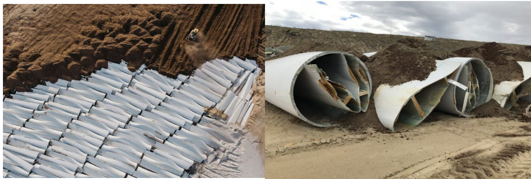
Obrázek 20: Likvidace listů rotorů vysloužilých větrných elektráren Zdroj: bloomberg.com
