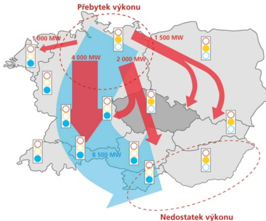
Obrázek 16 Problém přenosových soustav Střední Evropy Zdroj: vesmir.cz
